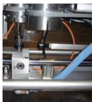
Głowice przegubowe igubal ® w maszynie cukierniczej
