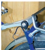
Głowice przegubowe igubal ® w mechanizmie tylnego zawieszania roweru
