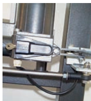
Głowice przegubowe igubal ® w mechanizmie zamykania bramy zewnętrznej
