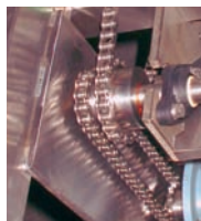
Łożysko kołnierzowe igubal® w napędzie przenośnika pasowego
