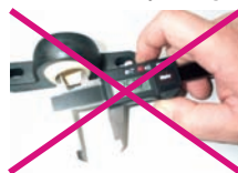
Niewłaściwy sprzęt testujący; sumniarka
