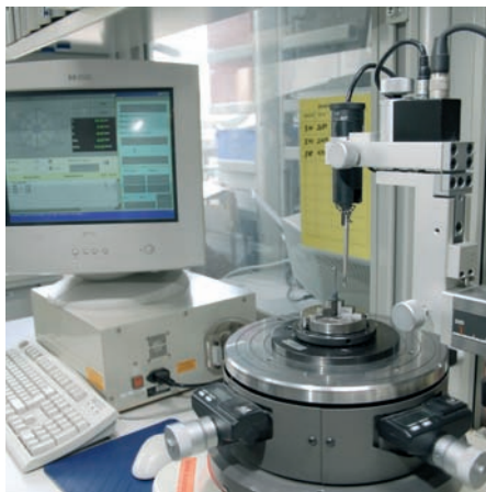
Pomiar wewnętrznej średnicy pasowanego łożyska ślizgowego
